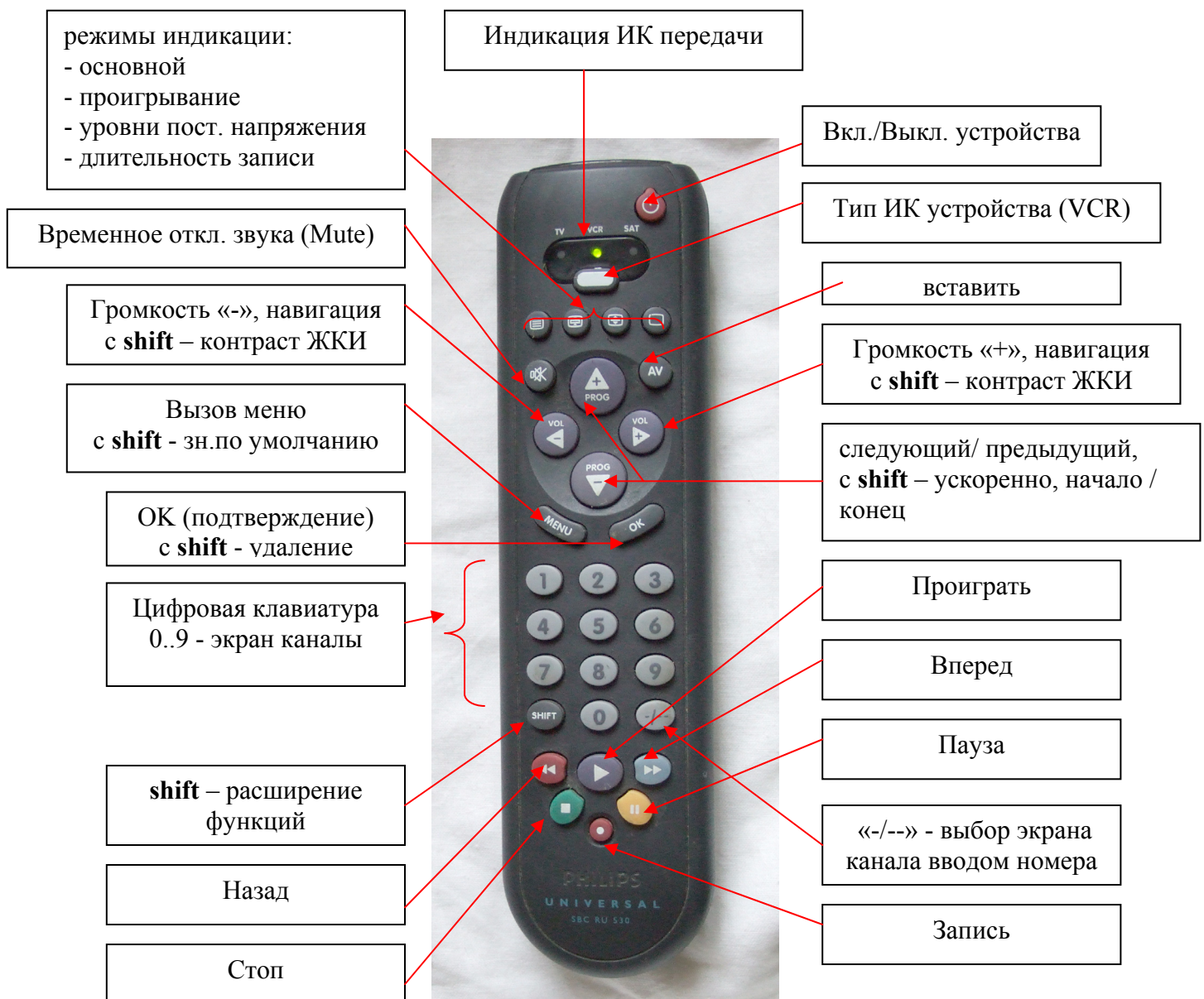
Рисунок 18. Управление ИК пультом (на примере пульта SBC RU530)
