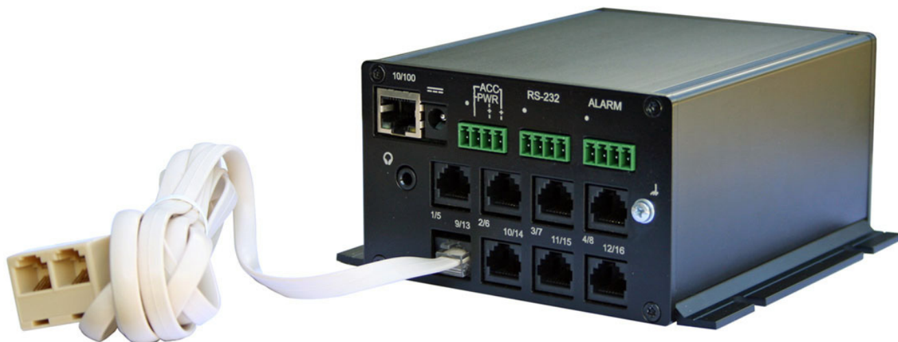
Рисунок 4. Вид с подключенным адаптером (раздельные входы RJ-12).
