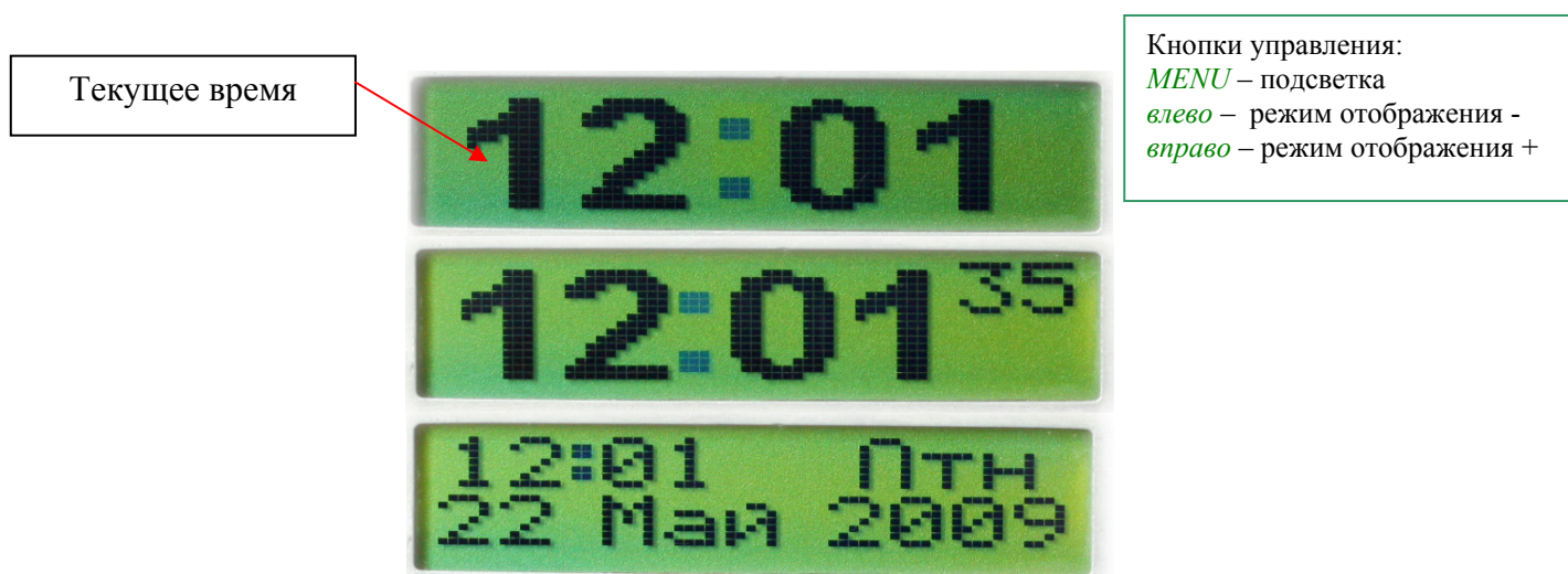
Рисунок 18. ЖКИ экран в режиме «выключено» с индикации текущего времени в различных режимах.
