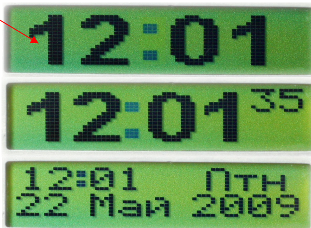
Рисунок 18. ЖКИ экран в режиме «выключено» с индикации текущего времени в различных режимах.
