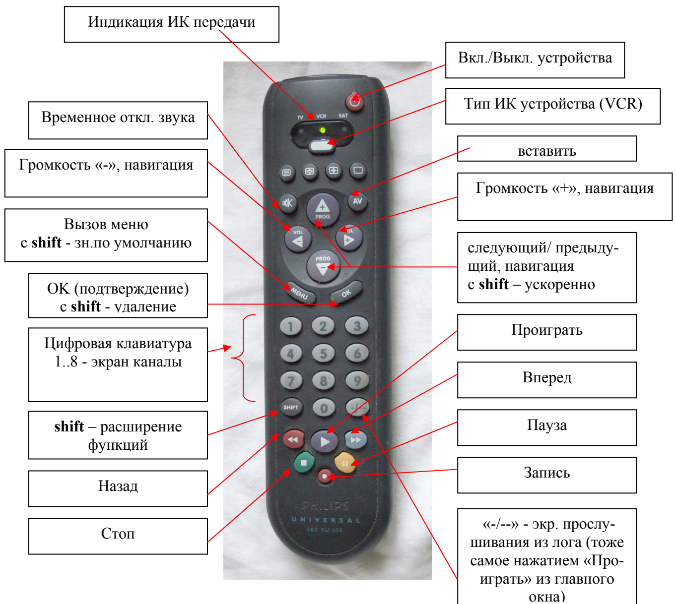
Рисунок 19. Управление ИК пультом (для исп. -03, на примере пульта SBC RU530)
