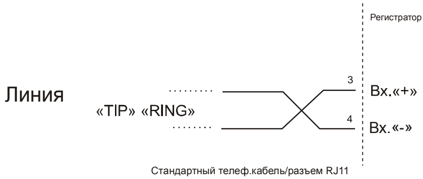
Рисунок 10. Схема подключения к телефонной линии.
